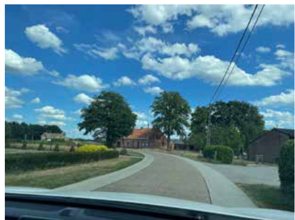
Oud-Turnhout. Verbreding van de rijbaan met een licht beton. De kernrijbaan is donkerder waardoor een versmallend effect optreedt. Dit kan een positief effect hebben op de snelheid. De lichte stroken markeren ook visueel de rand van weg, voertuigen raken minder snel ongewenst van de weg.
