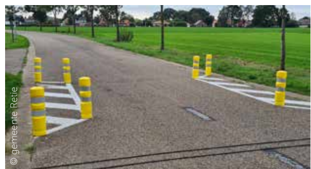
Retie. Proefopstelling van een versmalling. Doel is om de snelheid te vertragen. Aandachtspunt: zorg ervoor dat brede landbouwvoertuigen de versmalling kunnen passeren (zie ook bij 3.2).
